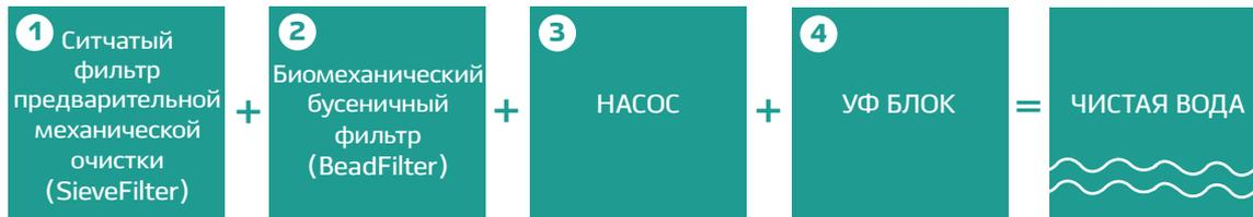
На схеме ниже представлено расположение и последовательность работы элементов системы:
